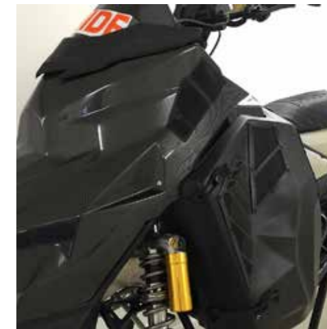
Brett Rasmussen teki yhteistyötä Öhlinsin kanssa ja myös Willen viimetalvisessa kelkassa oli ruotsalaiset iskarit. Nyt Brett kehittää Foxeja ja niissä hän käyttää samanlaisia progressiivisia tuplajousia kuin kuvassa. Brett itse kutsuu niitä regressiivisiksi. Nimityksestä viis, sillä idea on kuitenkin se että lyhyt ja löysä pikkujousi myötä alussa herkästi ja helpottaa esimerkiksi viistorinteillä kallistelua.
